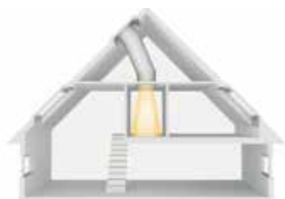
Zastosowanie światlika do dachów skośnych
