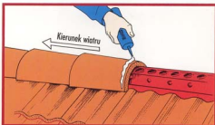
Rys. 14 Gąsiory kładzie się w kierunku pod wiatr. Uszczelnij i przybij.
