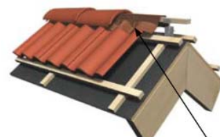
wykonanie taśmy zabezpieczającej kalenicę (Aerogratrolle)
